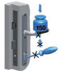
Der Drücker darf nur im normalen Drehsinn belastet werden. In Betätigungsrichtung darf auf den Drücker nur maximal eine Kraft von 150N aufgebracht werden. Das Schloss darf nur mit dazugehörigem Schlüssel und nicht mit artfremden Gegenständen geschlossen werden.
