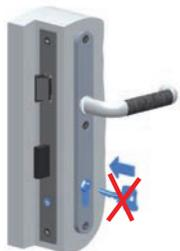
Beschädigte Schlüssel dürfen nicht in den Zylinder eingeführt werden.
