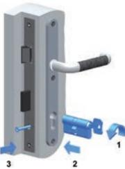
1. Mit Hilfe des Schlüssels die Schließnase bündig zum Gehäuse drehen.
