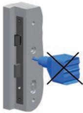
Das Türblatt darf im Schlossbereich nicht bei eingebautem Schloss durchbohrt werden.
