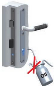
Der Zylinder darf nicht mit Hilfe von Öl geschmiert werden.
