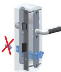
Bei steckendem Schlüssel ist eine Schließung von der anderen Seite nicht möglich. Ausnahme: Not- und Gefahrenfunktion.
